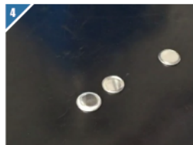
■ 从拆口模具中取出拆卸下来的正负极纽扣电池壳。
