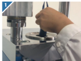
■ 将橡胶模具放到等静压腔体中。
