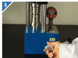
■ 松开泄压阀，将压力释放。
