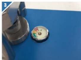
■ 保压一段时间后，将压力释放并取出模具。
