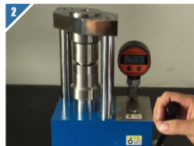
■ 打压到所需压力，直到纽扣电池正负极分开。
