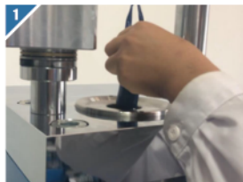
■ 将橡胶模具放到等静压腔体中。
